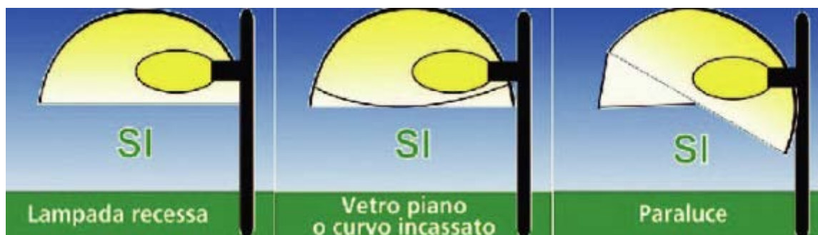
Figura 2: Tipologie di corpi illuminanti conformi alla L.R. 19/2003
