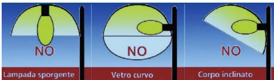
Figura 1: Tipologie corpi illuminanti non conformi alla L.R. 19/2003
