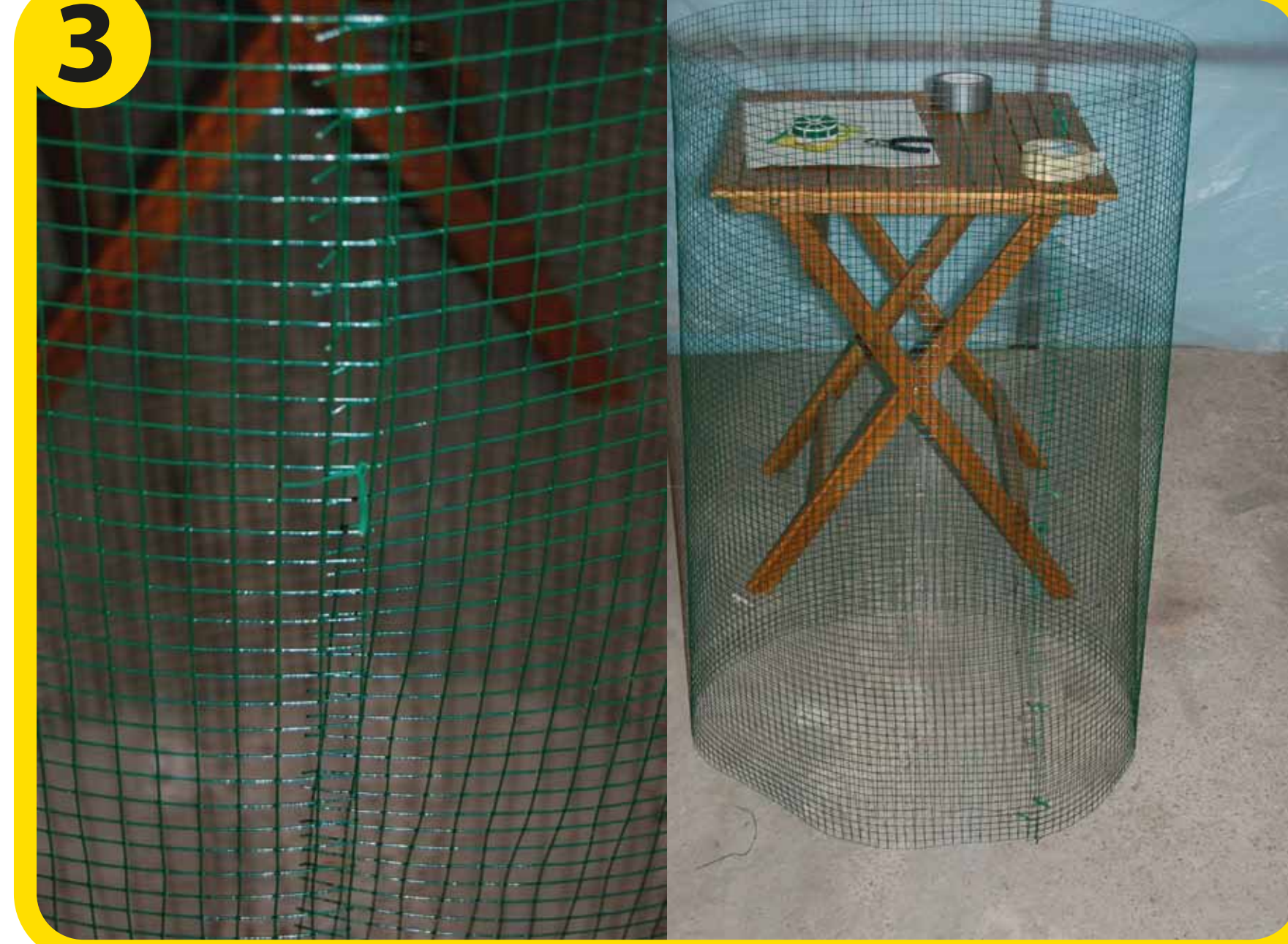
formare un cilindro con rete tagliata e fissarlo con alcuni pezzetti di filo di ferro
