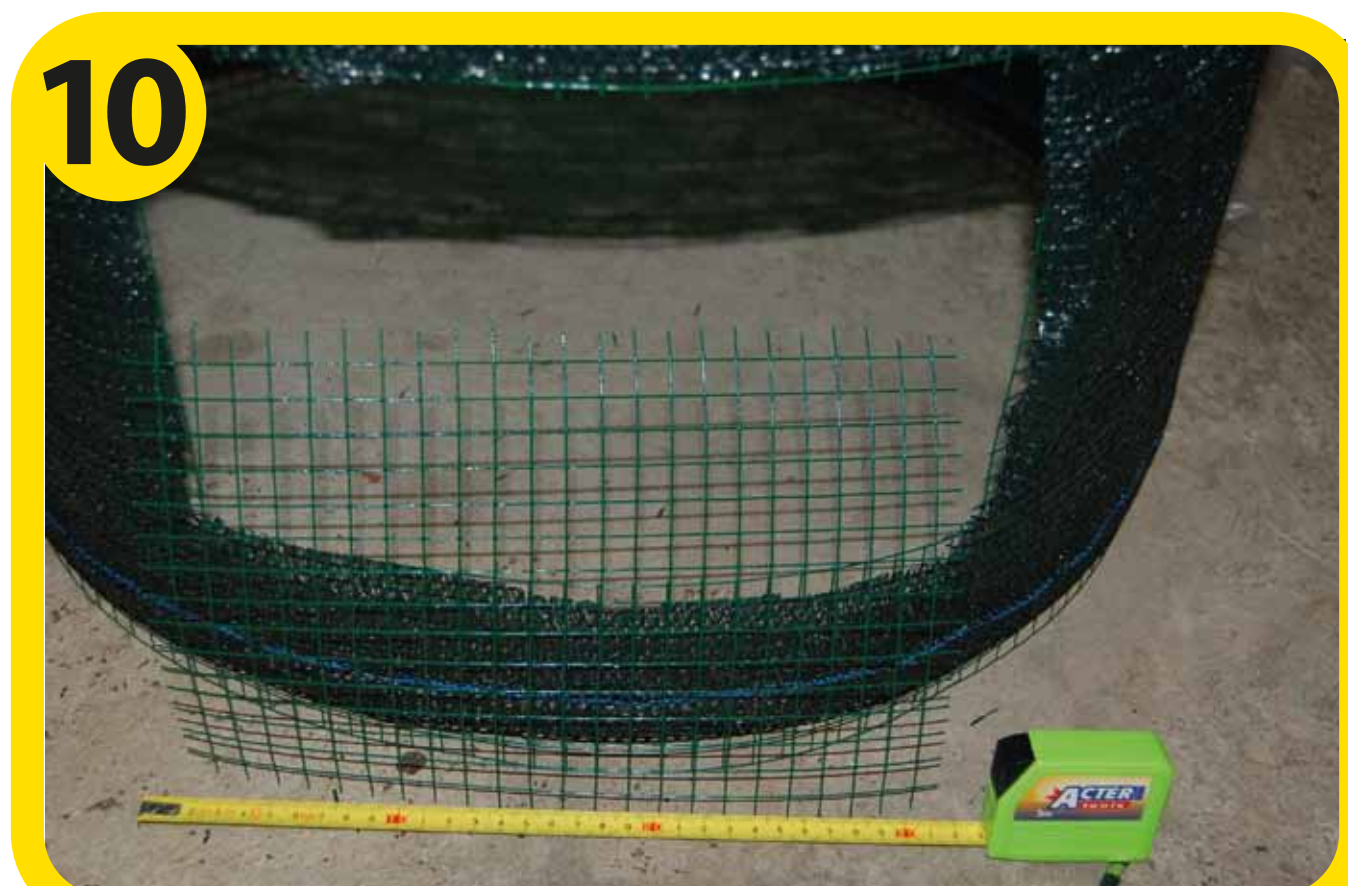
nella parte bassa del cilindro ricavare uno sportellino di 30 cm x 20 cm (o 30 cm x 30 cm).
