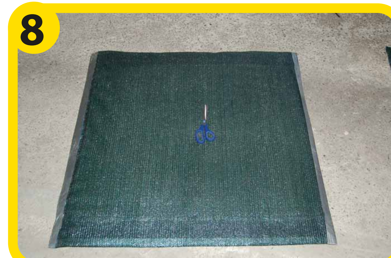
Applicare sulla rete metallica della rete ombreggiata (sempre di 1m x 1m) e fissarla con filo di ferro e nastro telato
